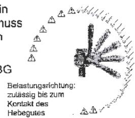
8. Das Anschlagmittel muss im VLBG frei beweglich sein. Beim An- und Aushängen der Anschlagmittel (Anschlagkette) dürfen für die Handhabung keine Quetsch-, Scher-, Fang- und Stoßstellen entstehen. Schließen Sie Beschädigungen der Anschlagmittel durch scharfkantige Belastung aus.
