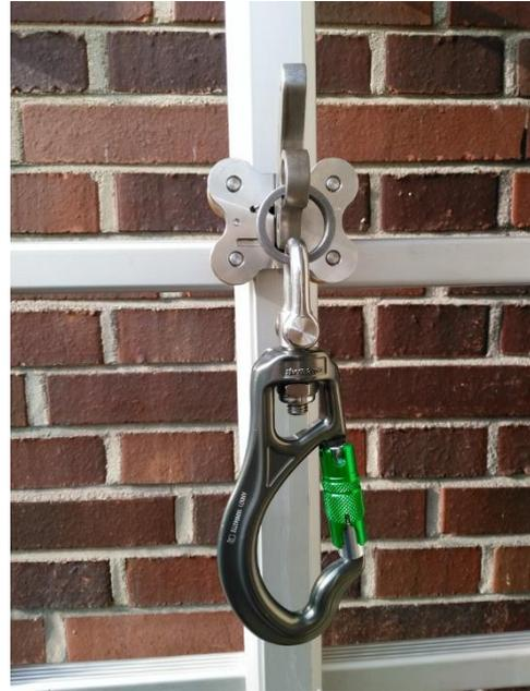
Bild 7: VSS-Läufer auf Aluminiumleiter
