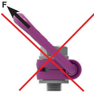
Abb. 1: Verbotene Belastungsrichtung
