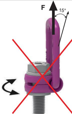
Abb. 7: Verbotene Drehbewegung bei Belastung in Achsrichtung
