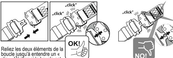
Reliez les deux éléments de la boucle jusqu'à entendre un « clic ». Vérifiez si la boucle est bien bloquée et si elle fonctionne correctement.
