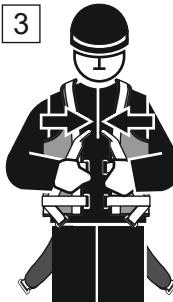
Fermer les deux boucles des sangles poitrine et hanche. Réglerez ajuster la longueur de ces sangles. Il est interdit d'utiliser le harnais de sécurité avec les boucles ouvertes.
