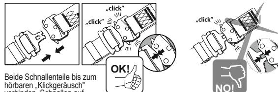
Beide Schnallenteile bis zum hörbaren „Klickgeräusch“ verbinden. Schnallen auf versperzte Position und korrekte Funktion prüfen.
