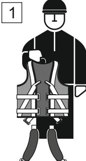
Soulever le harnais en le tenant par la boucle d'attelage arrière. Les ceintures pour cuisses doivent être ouvertes et pendre librement.
