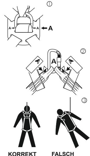
Die hintere Auffangöse wird mit A bezeichnet und befindet sich am Kreuzstück mit den auf die Öse gerichteten Pfeilen.
