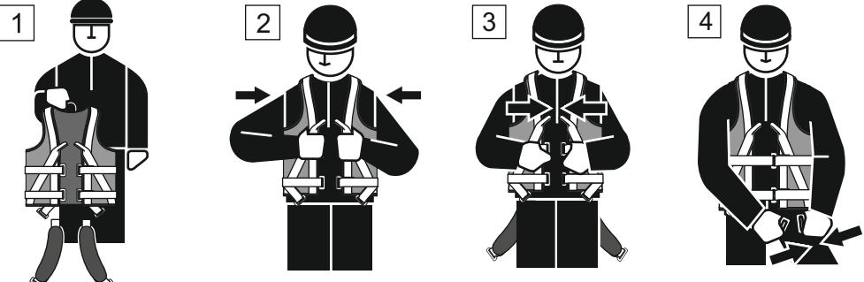
Sicherheitsgurtsystem an der hinteren Auffangöse heben. Die Oberschenkelgurte müssen geöffnet sein und frei hängen.
