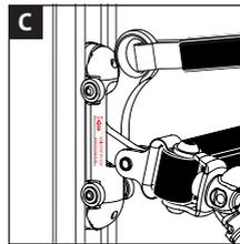
**C** Darauf achten, dass der Hinweispeil nach oben zeigt. Beim Loslassen des Auffanggerätes verriegelt das Gerät auf der Schiene selbstständig. Funktionskontrolle durch Auf- und Abfahren des Auffanggerätes von Hand auf der Schiene. Bei ruckartiger Bewegung nach unten oder Loslassen muss das Gerät sperren!
