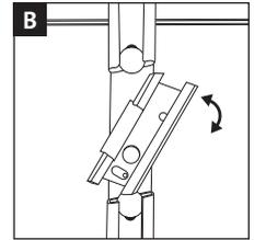
**B** Arretierbolzen nach hinten ziehen und die Entnahmeklappe im Uhrzeigersinn bis zum Anschlag schwenken. Auffanggerät mit dem Sicherheitsstift rechts weisend einsetzen. Die integrierte Einschubsicherung verhindert ein falsches Einsetzen. Entnahmeklappe wieder schließen! In die Durchgangsstellung zurückschwenken und den Arretierbolzen in die Einrastbohrung schnappen lassen.
