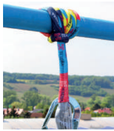
Abb.3: Horizontale Anbringung, hier mehrmals um die Struktur gelegt.
