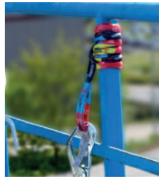
Abb.2: Vertikale Anbringung, hier mehrmals um die Struktur gelegt.
