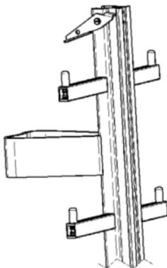
*Abb.8 Bsp. Al- Einholmleiter mit beweglichem Endanschlag*
