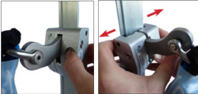
d) Den Hebel anheben und den Läufer so neigen, dass er parallel zur Sicherheitsschiene ist.
