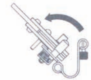
Seilklemme entriegeln und öffnen
