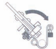
Seil einlegen und Seilklemme schließen
