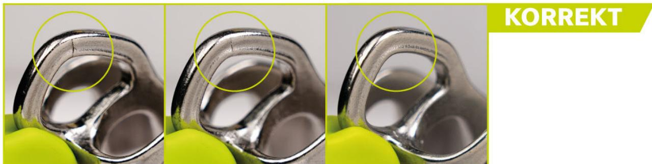
Geräte, die an dieser Stelle eine Stufe oder Kante wie hier abgebildet aufweisen, können weiterverwendet werden. Sie müssen nichts tun.
