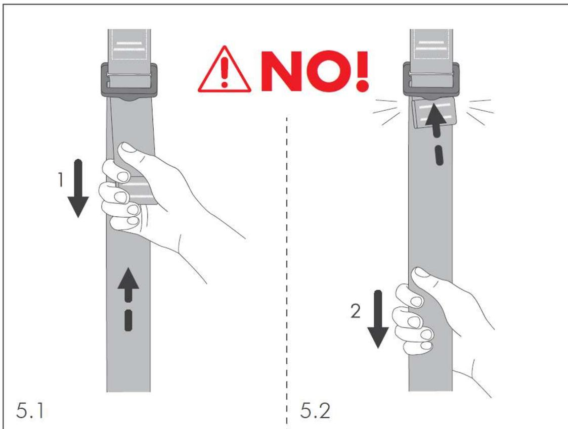
Führen Sie für jede Schnalle eine Funktionsprüfung des Verstellsystems durch.
