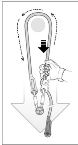
**ZIGZAG / ZIGZAG PLUS:** Führen Sie einen Funktionstest mit Ihrem Seil (kompatible Seildurchmesser: 11,5 mm bis 13 mm). Installieren Sie das ZIGZAG am Doppelstrang. Hängen Sie sich in sehr geringem Abstand zum Boden in das Seil.
