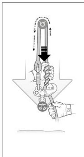
Wenn Sie an einem am Doppelstrang installierten ZIGZAG hängen, müssen Sie blockiert sein. Vergewissern Sie sich, dass das Seil gleichmäßig und kontrolliert durch das Gerät läuft, wenn Sie auf den Entriegelungshebel drücken.
