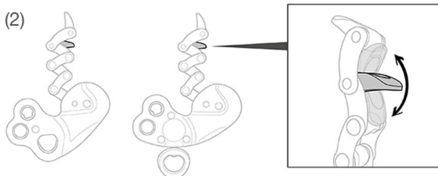
Überprüfen Sie die Effizienz der Rückholfeder des oberen Entriegelungshebels (1) und die Gängigkeit des unteren Entriegelungshebels (2) für den ZIGZAG / ZIGZAG PLUS. Wiederholen Sie den Test etwa zehnmal.
