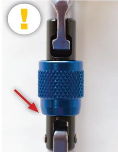
VERRIEGELUNGSHÜLSE IST KORREKT AUSGERICHTET
