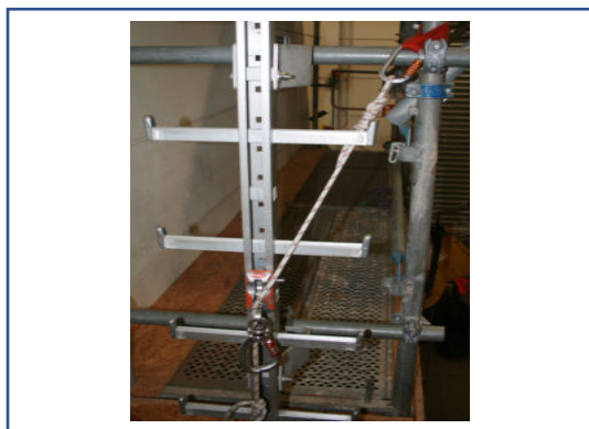
Bilder vom Versuch mit Seilverlauf über die Kante des aufgezogenen Läufers (Quelle: Thomas Wahls)
