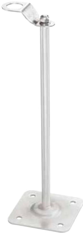
Absturzsicherungssystem mit integriertem Fallindikator zur einfachen und schnellen Befestigung auf Beton und Wärmedämmverbundsystemen (WDVS) mittels der bewährten Würth Dübeltechnik. Geprüft nach DIN EN 795:2012.
