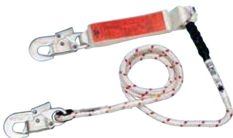
**Hinweis:** Der Bandfalldämpfer löst bei einer statischen Last von ca. 200 kg aus, absorbiert Fallkräfte und reduziert sie auf ein körperverträgliches Maß von weniger als 600 kg. Beim Sturz kann sich der Bandfalldämpfer um max. 1,55 m verlängern.
